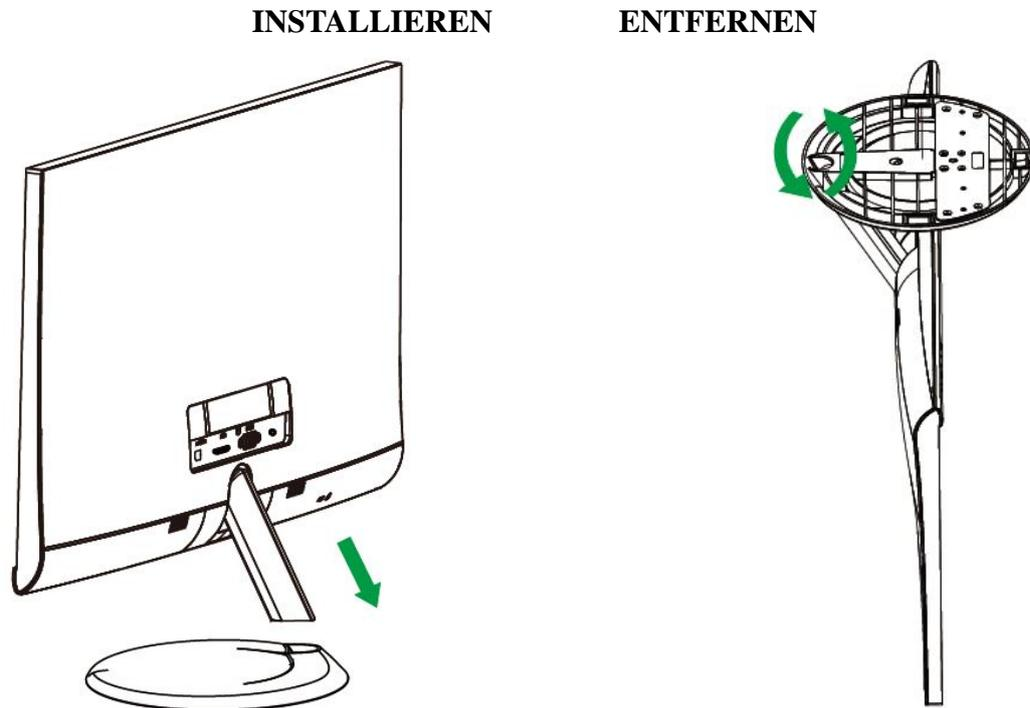
ABBILDUNG 1. INSTALLIEREN UND ENTFERNEN DES STÄNDERS
