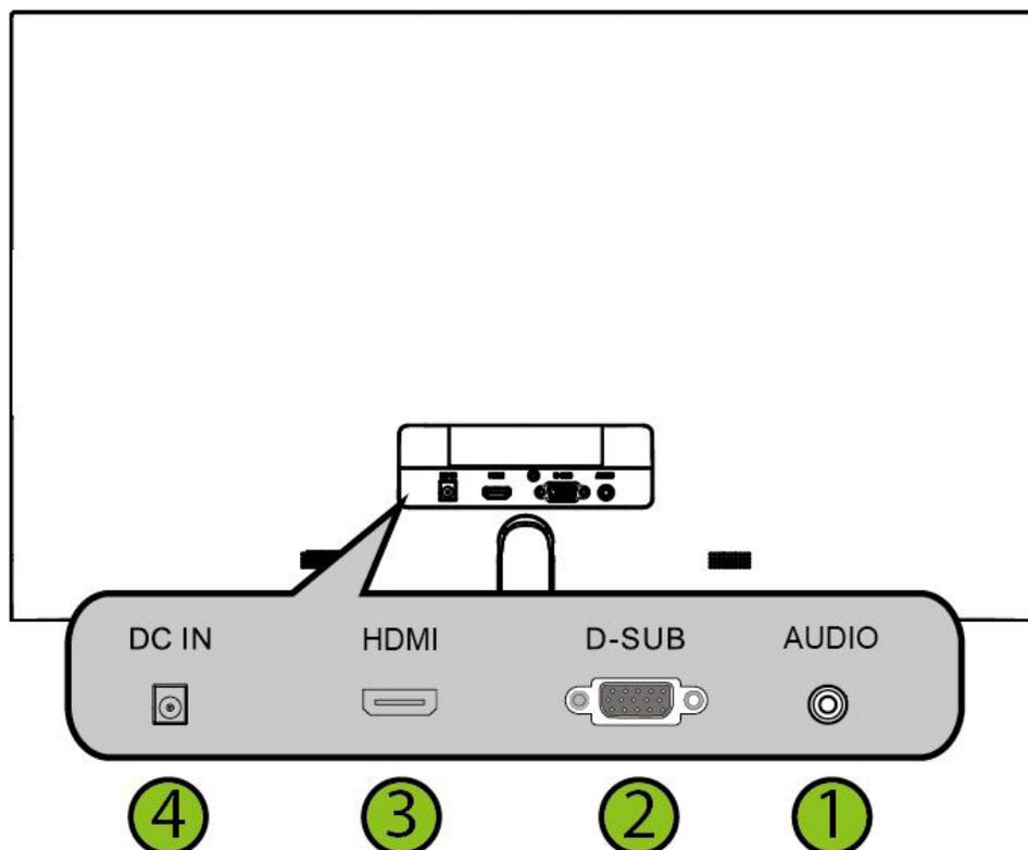
ABBILDUNG 2. ANSCHLISSEN AN EINEN PC
