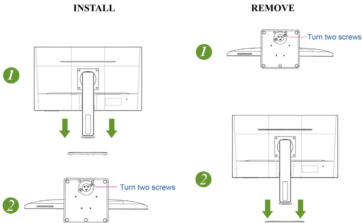
ABBILDUNG 1. INSTALLIEREN UND ENTFERNEN DES STÄNDERS
