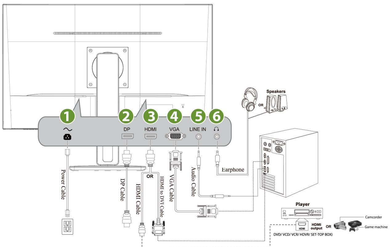
ABBILDUNG 2. ANSCHLISSEN AN EINEN PC
